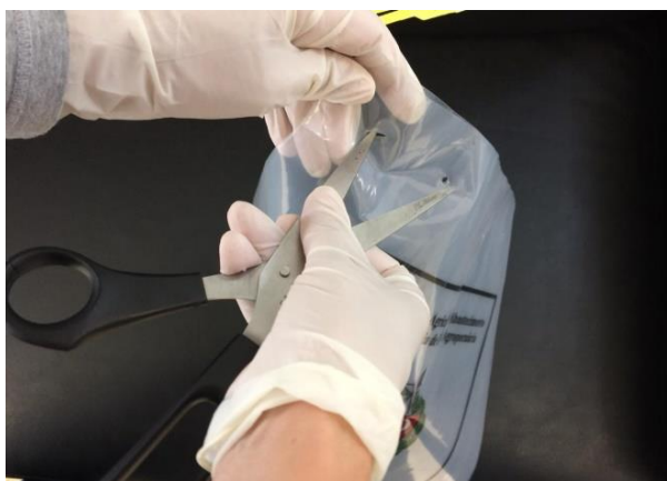
a) Confeção de furos ao longo da abertura do saco plástico.
