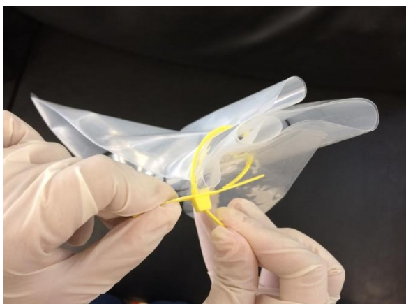
c) Fechamento do lacre transpassando todos os furos contidos na parte superior do saco (abertura).
